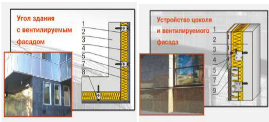
Рис. 3. Монтаж изовента
